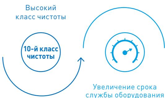
70-80 % выходов из строя гидравлических систем зависят от загрязнения рабочей жидкости\*. При производстве Gazpromneft Hydraulic HZF используются современные системы фильтрации фирмы PALL, удерживающие частицы размером 3-5 микрон. Благодаря этому обеспечивается фильтрация до 10-го класса чистоты. В случае особой необходимости путем дополнительной фильтрации возможно достижение 8-го класса чистоты.
